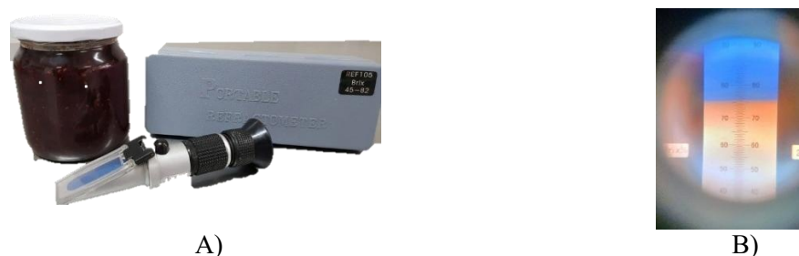
Figura 7. 8 Determinación de °Brix. A) muestra y equipo utilizado para la prueba, B) resultado obtenido
