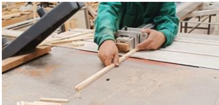
Figura 7. Elaboración de probetas para durabilidad de la madera.
