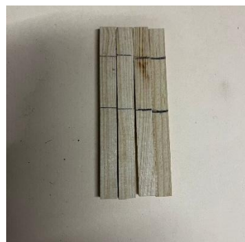
Figura 8. Marcado de probetas para durabilidad de la madera.
