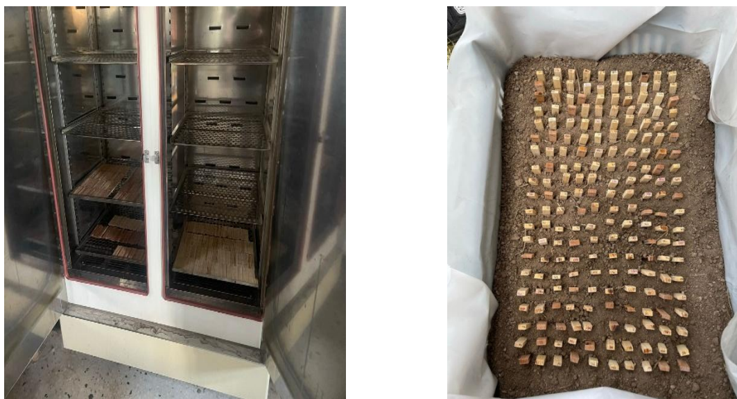
Figura 12. Secado e instalación de probetas en el microcosmos terrestre.
