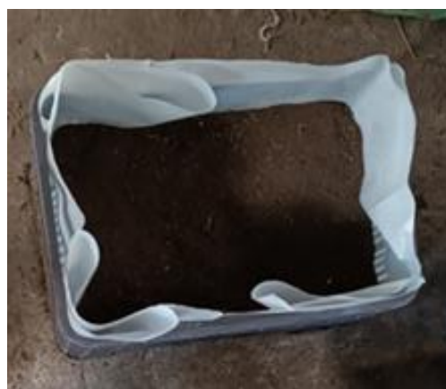
Figura 9. Preparación del suelo para el ensayo de durabilidad de la madera.
