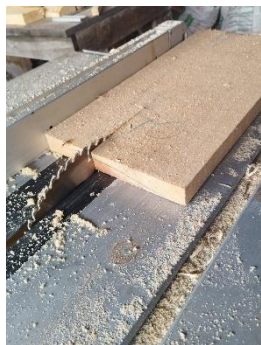
Figura 7. Elaboración de probetas para durabilidad de la madera.
