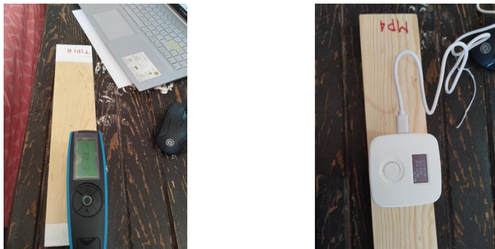
Figura 14. Toma de información de color y brillo de las probetas.
