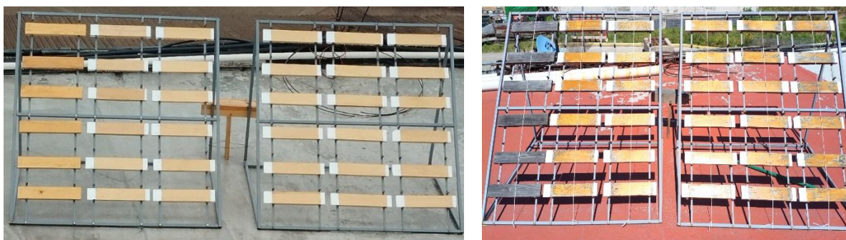
Figura 15. Exposición de las probetas a la radiación UV.
