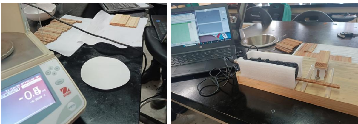
Figura 11. Pruebas de frecuencia en las probetas de madera.
