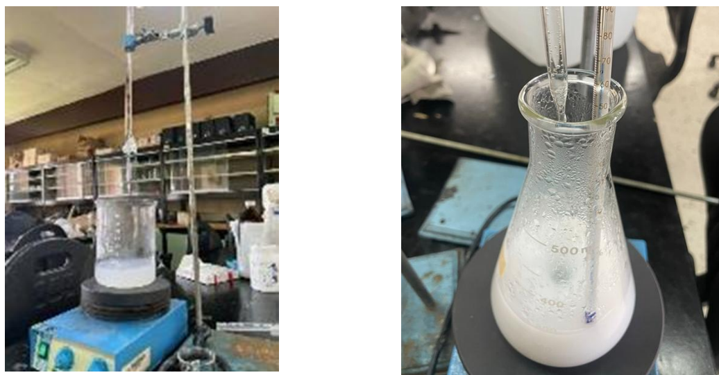
Figura 6. Síntesis de nanopartículas de óxido de zinc (ZnO).
