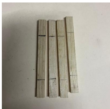
Figura 8. Marcado de probetas para durabilidad de la madera.
