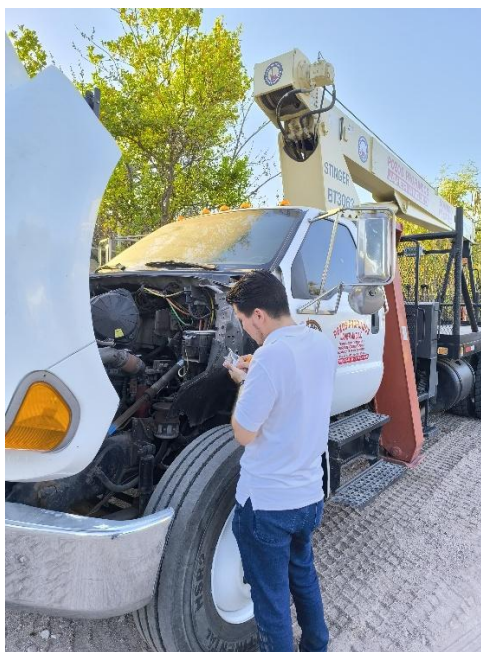
Figura 15: Revisión e inspección del compartimiento del motor de grúa hidráulica.
