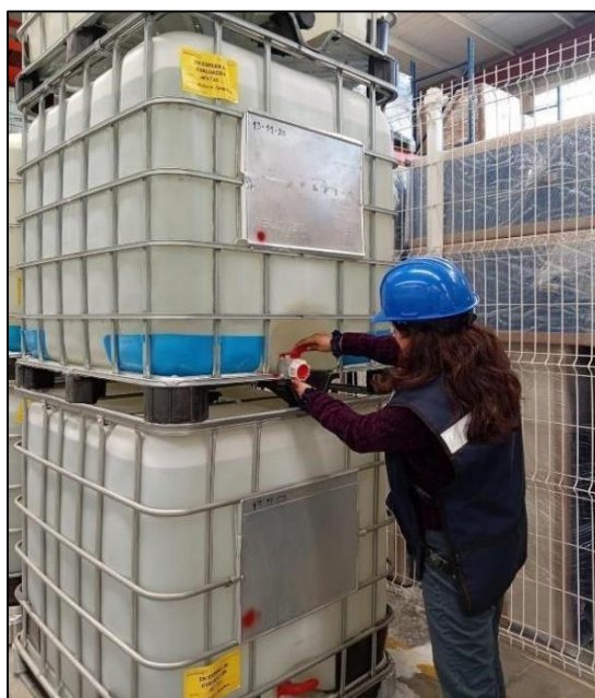
Ilustración 41. Verificación técnica de estanqueidad y control de producto no conforme en válvulas.
