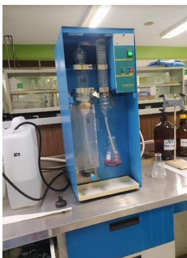
Figura 18. Colocación del tubo de digestión en el destilador y el matraz en el tubo de salida del destilado.
