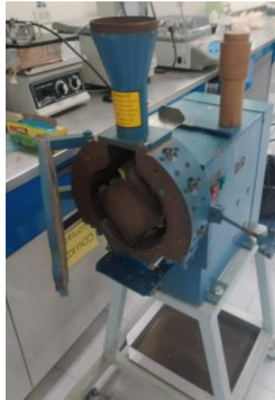
Figura 12. Equipo ‘Thomas Wiley Laboratory Mill Model 4’ usado en la molienda de tejido vegetal seco y obtención de la muestra para realizar la evaluación de nutrimentos de Vinca.
