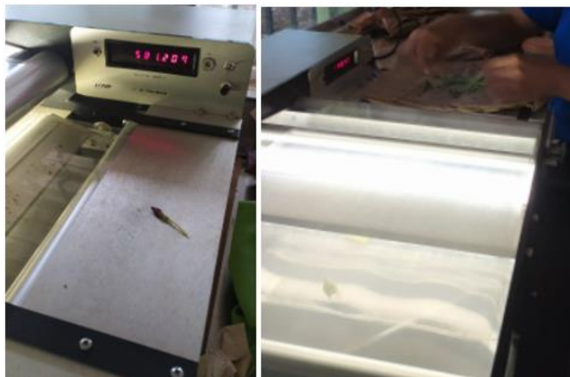
Figura 10. Medición de área foliar en el cultivo de Vinca con LI-3100C Area meter.
