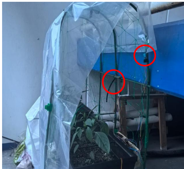
Figura 11 Fijación de sensores de temperatura ambiente (DHT11) y sensor de radiación solar (BH1750)
