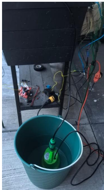
Figura 13 Bomba de agua sumergible para suministrar agua al cultivo
