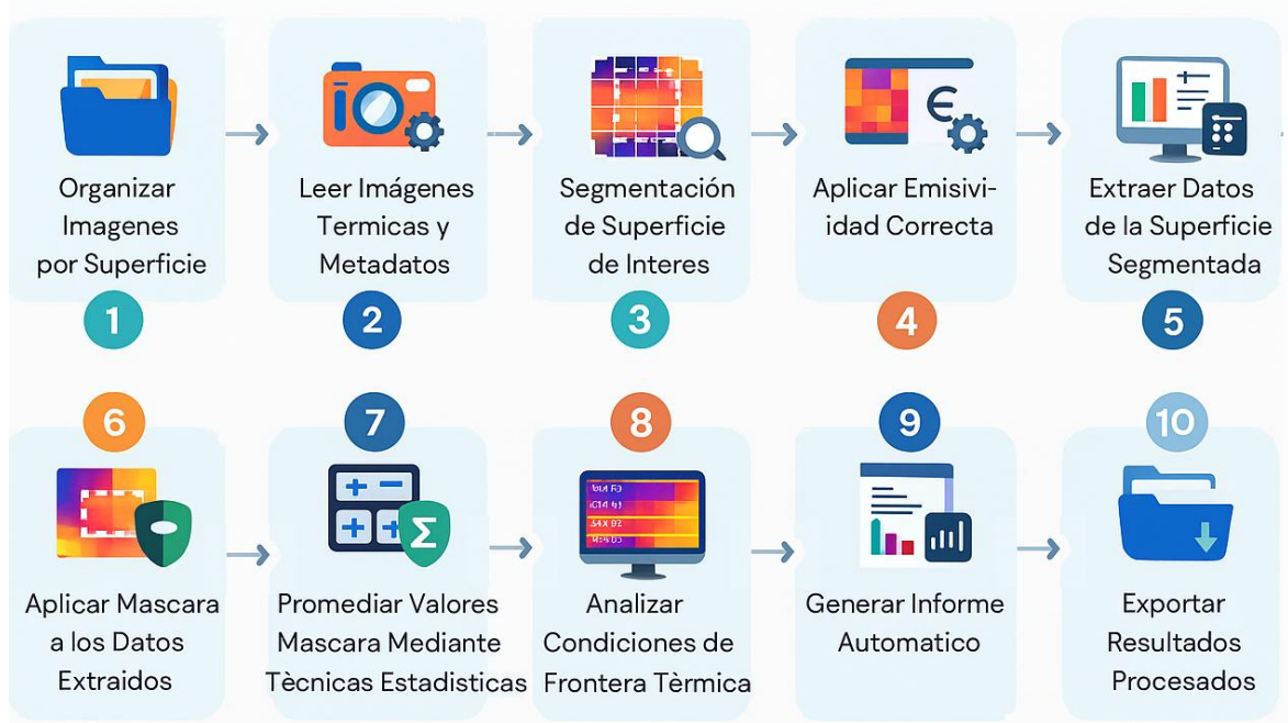
Figura 3. 22. Flujo de procesamiento en Python para la conversión de imágenes termográficas en datos de temperatura superficial promedio.
