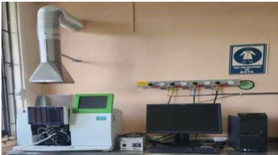
Figura. 5.- Espectro de absorción atómica, localizado en el laboratorio de instrumentación analítica, Itescam.
