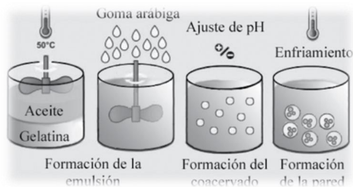
Figura 21. Diagrama del proceso de microencapsulación.
