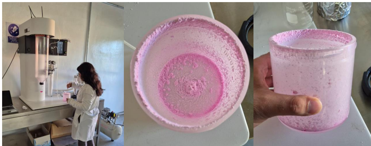
Figura 8. Microencapsulación de compuestos betalainas por el método de secado por aspersión.
