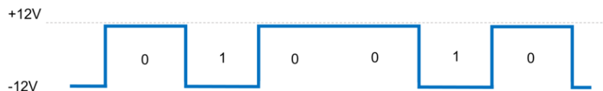
Figura 19. Representación de niveles de voltaje RS232.
