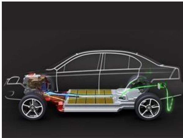
Figura 15: Batería de Vehículo eléctrico
