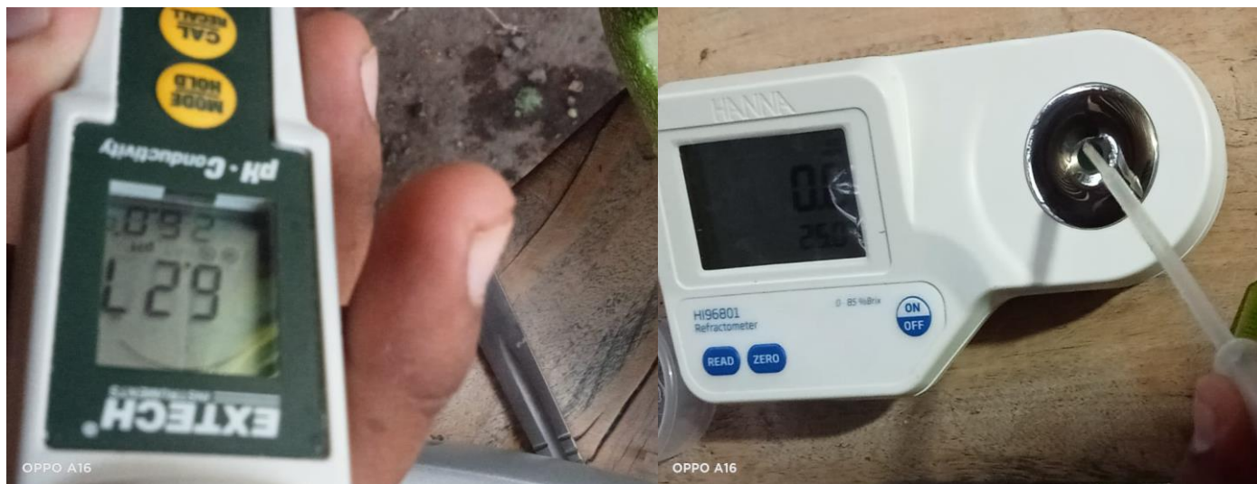
Figura 10. Medición de pH y grados brix con un refractómetro digital con el jugo que se extrajo de la pulpa.
