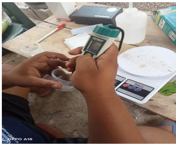
Figura 6. Calibración del potenciómetro
