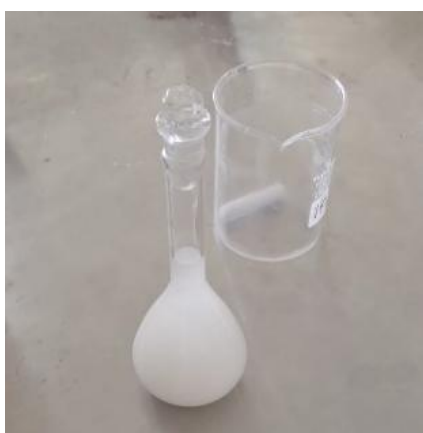
Figura 2.1: Matraz de 100 ml conteniendo la solución de celulosa, almidón y glicerol.
