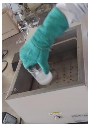
Figura 2.3: Matraz con la solución de celulosa y almidón, para ser introducido en el equipo ultrasónico.
