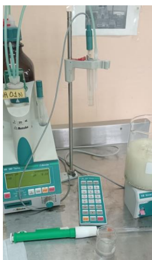
Figura 2.5. proceso de titulación de la solución con NaOH
