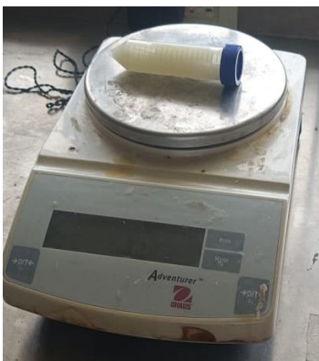
Figura 2.9. realizando la medición de la masa de cada tubo para mantener balanceado el rotor de la maquina
