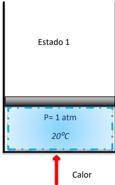
Figura 3.9.5 A 1 atm y 20^{\circ}\text{C} , el agua existe en la fase líquida (líquido comprimido)
