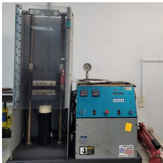
Figura 2.9 CARVER Auto series de 25 toneladas, dos platos y 280 watts.
