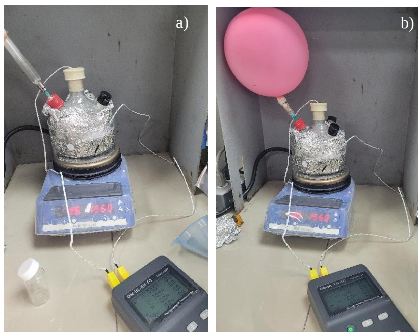
Figura 2.7 a) inyección del iniciador a la mezcla dentro del matraz, b) inyección de nitrógeno al matraz.
