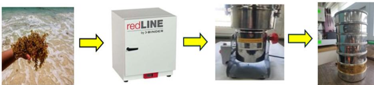
Figura 2.2 Proceso de obtención de partículas de sargazo.
