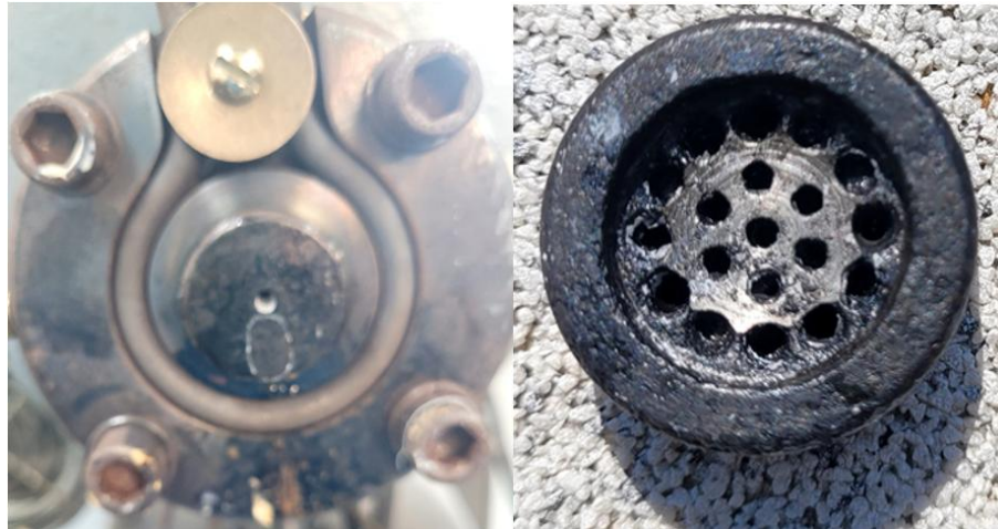
Figura 2.8. Dado monofilamento con resistencia (lado izquierdo) y malla del dado (lado derecho).
