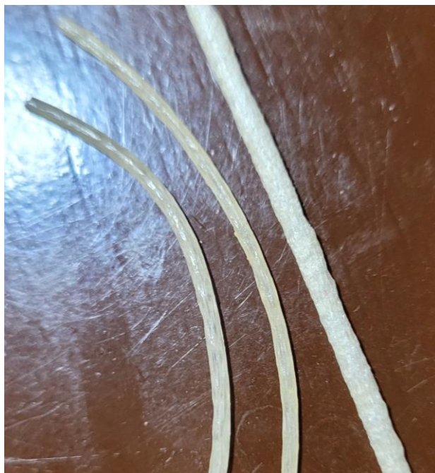
Figura 3.2. Filamentos obtenidos a partir de mezclas con distinto tiempo de secado.
