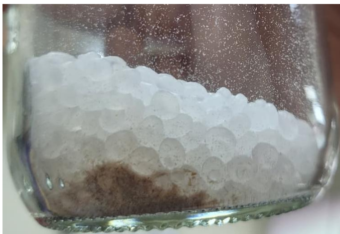
Figura 3.1. Mezcla de pellets de PP y partículas de cáscara de pistache.
