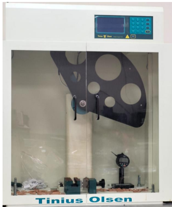
Figura 2.18. Medidor de pruebas de impacto Izod marca Tinius Olsen modelo IT503.
