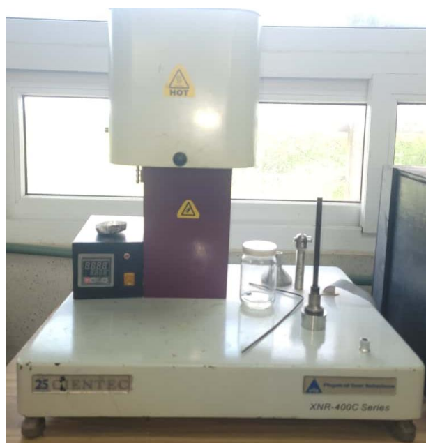
Figura 2.14. Plastómetro utilizado para la medición de índice de fluidez XNR-400C Series de Physical Test Solutions.
