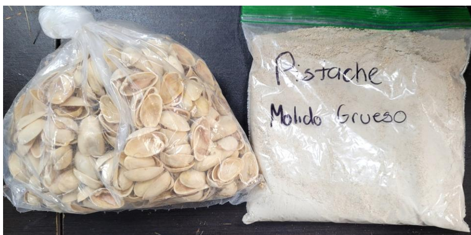
Figura 2.2. Cáscara de pistache seca entera y cáscara de pistache molida.
