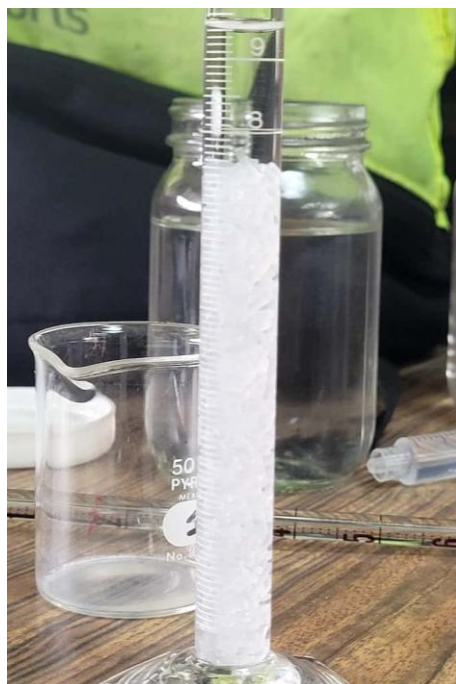
Figura 2.15. Probeta de 10 mL con pellets de filamento y etanol.
