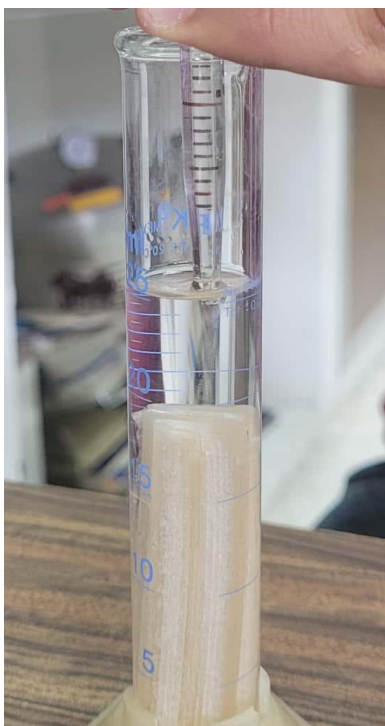
Figura 2.16. Probeta de 25 mL con probetas impresas y etanol.
