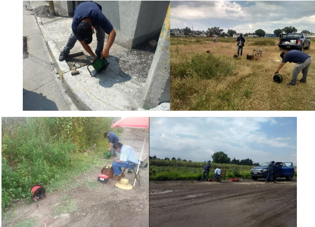
Figura 18 Realización de los SEVs
