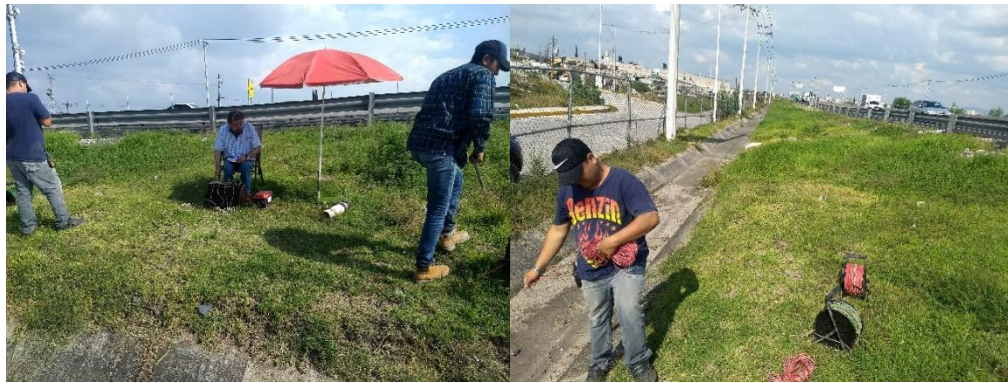
Figura 25 Ejecución del SEV 5
