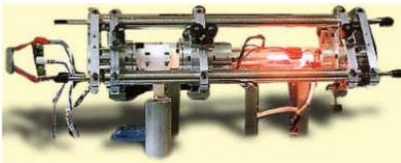
Figura 1 - Láser estabilizado en frecuencia al ^{127}\text{I}_2 desarrollado en el CENAM
