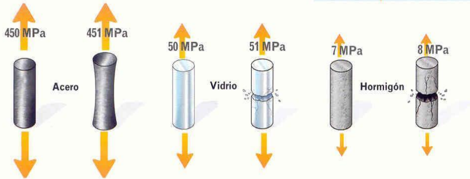
Figura 22. Representación de la Tracción
