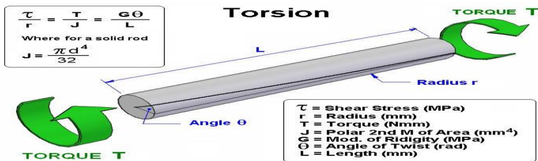
Figura 21.2 Representación de la Torsión
