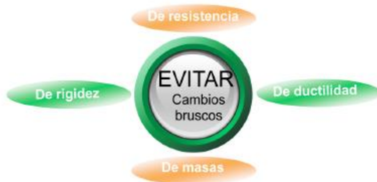
Ilustración 70. Evitar en edificios
