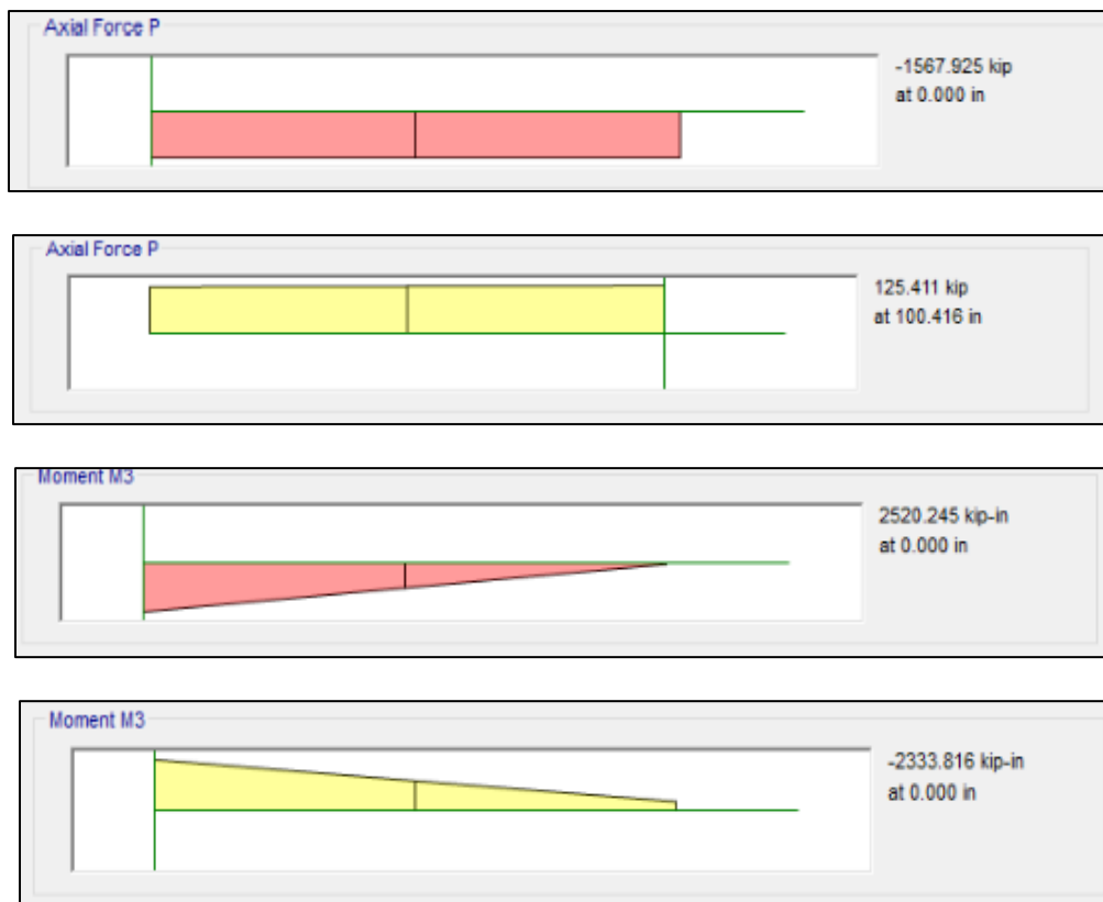
Ilustración 100. Compresión, tracción, y momentos flexionantes en columna tipo
