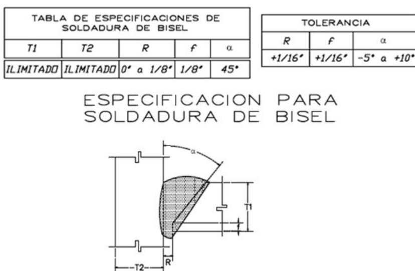
Ilustración 102. Soldadura de bisel
