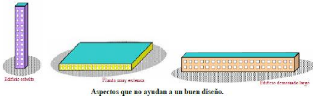
Ilustración 47. Formas en planta y elevación inadecuadas
