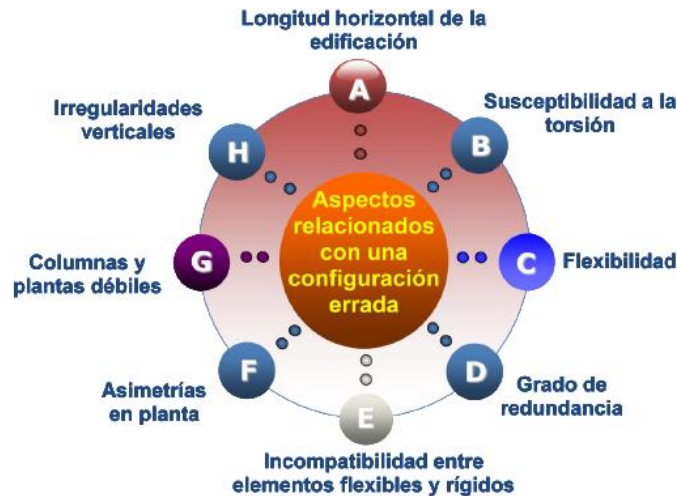
Ilustración 45. Errores de estructuración
