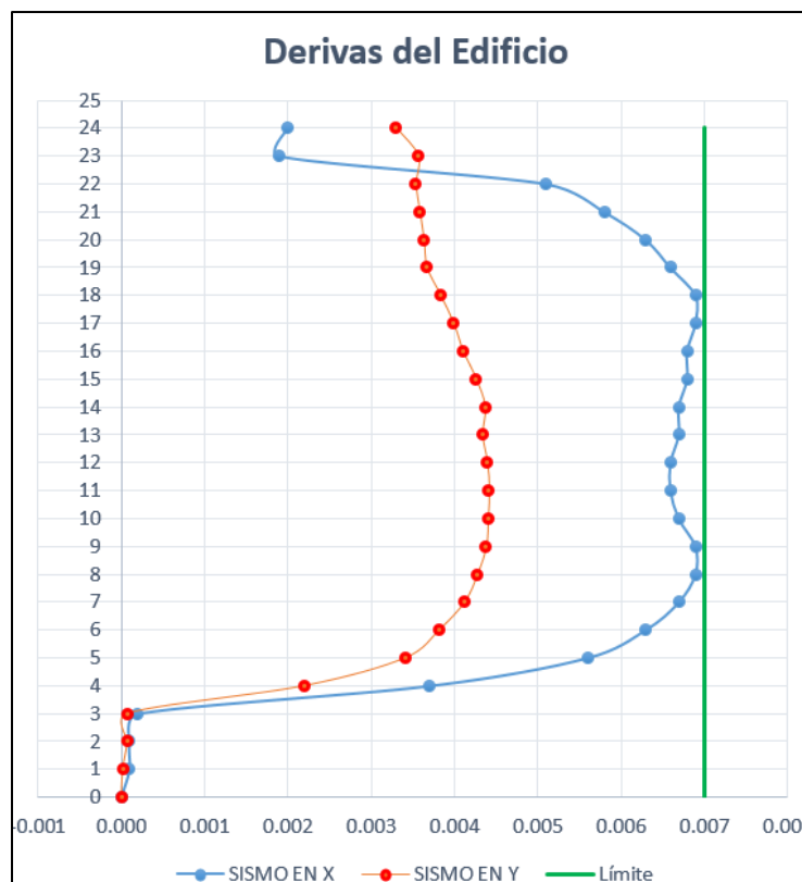
Ilustración 151. Control de las derivas del Edificio
