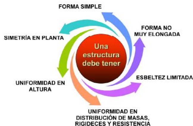
Ilustración 46. Requisitos de una buena estructuración
