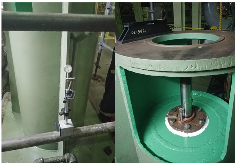
Figura 109. Nivelación con indicador de cuadrante y nivel de precisión.
