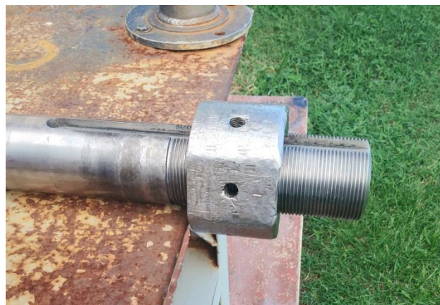
Figura 118. Tuerca de ajuste atascada en flecha motriz.
