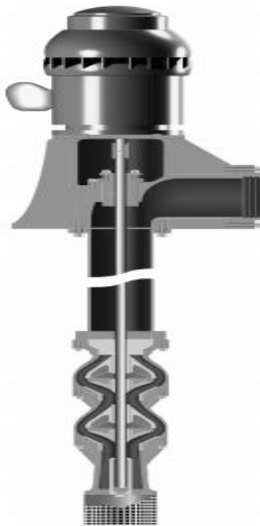
Figura 11. Bomba vertical de pozo húmedo.
