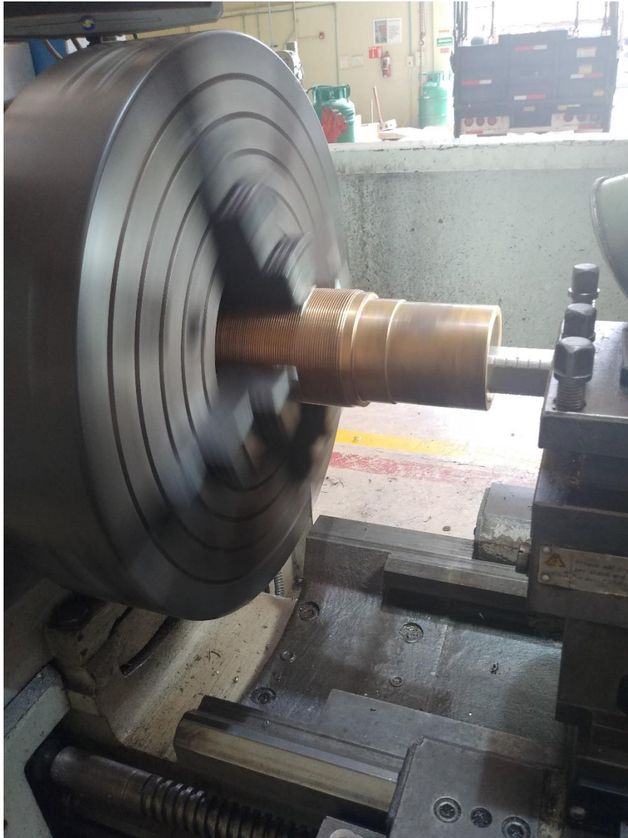
Figura 127. Rectificación en torno de chumacera roscada.
