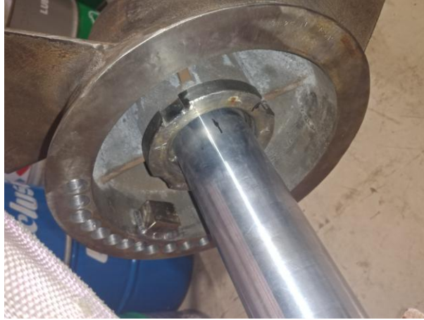
Figura 101. Placa en impulsores mal colocadas.
