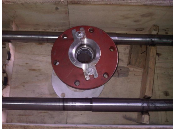
Figura 5. Estopero en condiciones inaceptables.
