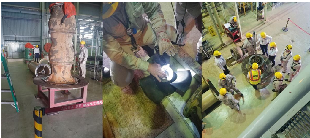
Figura 123. Inspección de partes de la bomba (Retrabajo).
