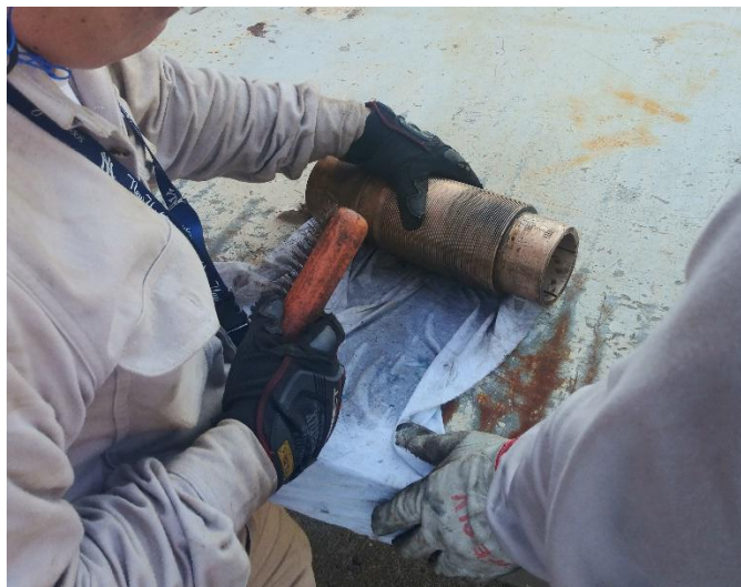
Figura 126. Limpieza de las cuerdas de la chumacera roscada.
