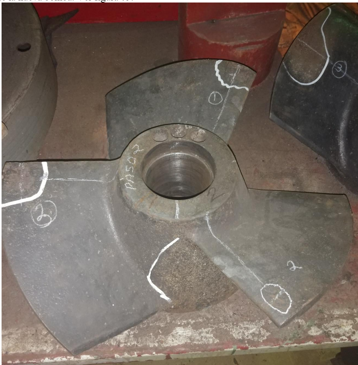
Figura 79. Inspección de impulsores usados de bomba anterior.
