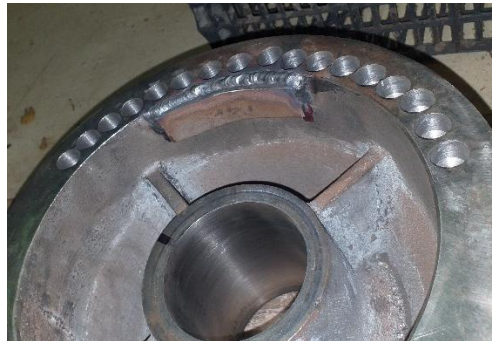
Figura 102. Placa en impulsor mejor colocada.
