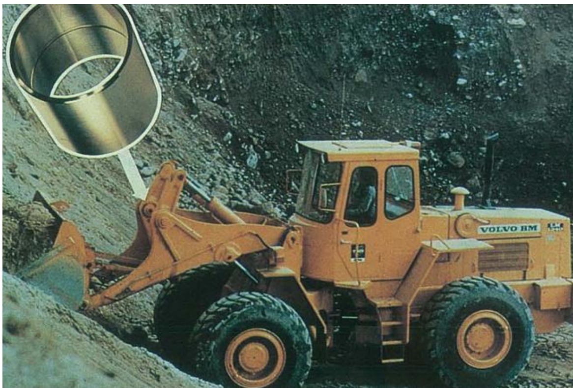
Figura 43. Bronce Naval Brass en rodamiento de manguito para maquinaria pesada.
