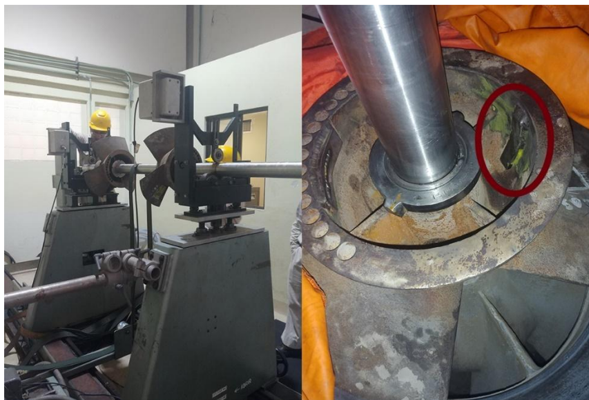
Figura 124. Balanceo del conjunto rotatorio (Retrabajo).
