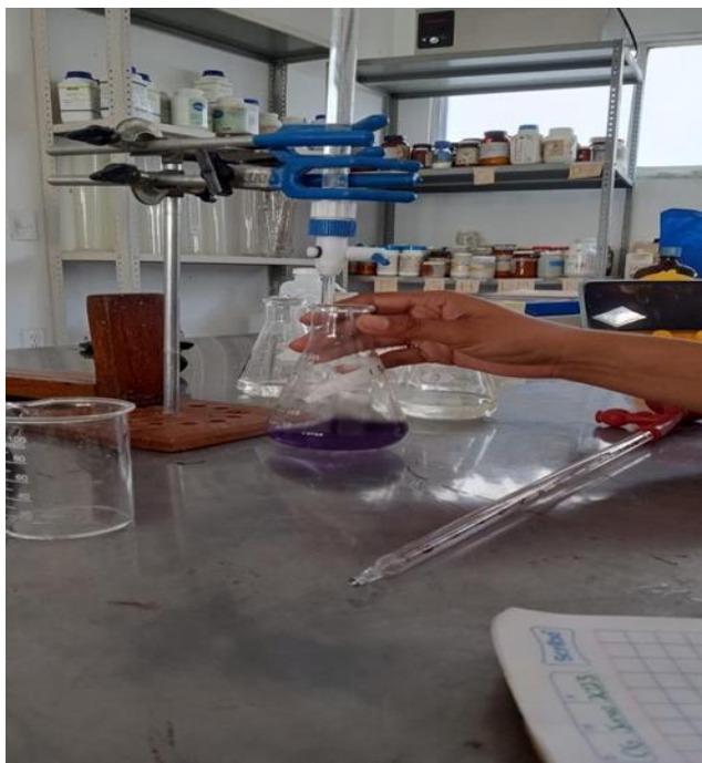
FIGURA 9. DETERMINACIÓN DE DUREZA DEL AGUA Y LA ABSORCIÓN DE CALCIO POR EL MÉTODO EDTA.
