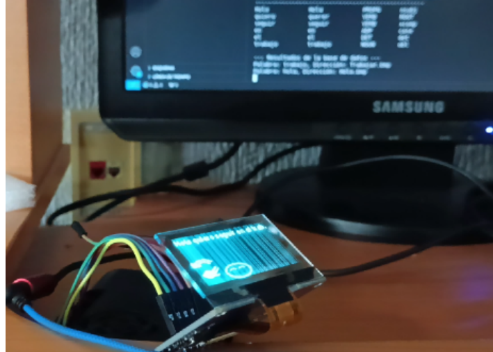
Figura 5.10 Prueba de funcionamiento con Raspberry Pi 4 y pantalla transparente
