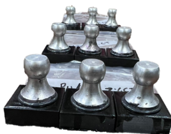
Figura 14: Probetas de los diferentes recubrimientos de PU/GO y PU/TiO 2 para pruebas de adhesión.
