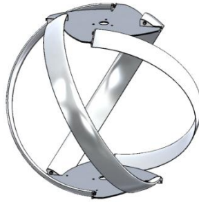
Figura 6. Modelo CAD de una turbina Lucid (Bachant & Wosnik, 2015).
