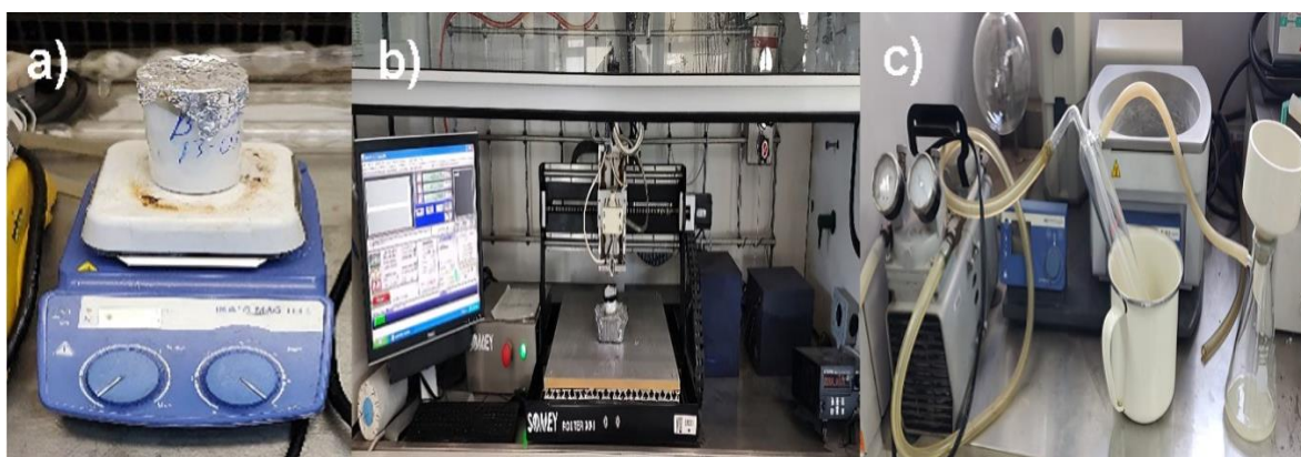
Figura 3.1 Formación de complejo de inclusión por plasma: a) agitación magnética, b) equipo de plasma y c) filtración a vacío de IC.
