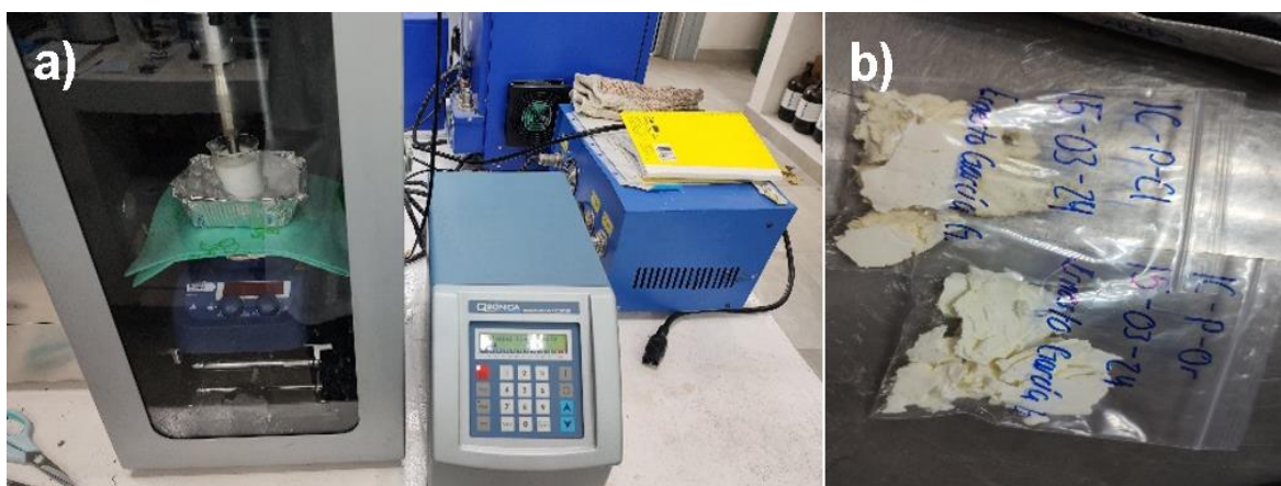
Figura 3.2 Formación de IC por ultrasonido a) Equipo de ultrasonido, b) Polvos de los complejos de inclusion formados IC-P-Cl, IC-P-Or.
