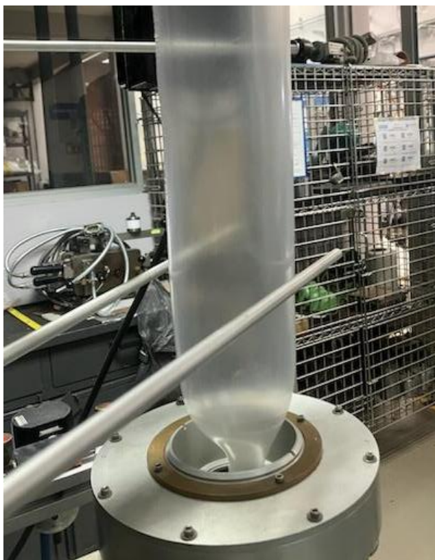
Figura 2.10 "Fabricación de película soplada obtenida en el CIQA"
