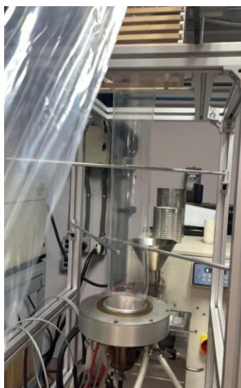
Figura 3.3 "Fabricación de película soplada mediante extrusión por soplado"
