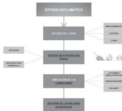
Gráfico N° 12 Esquema de elementos para un estudio bioclimático de una edificación.
