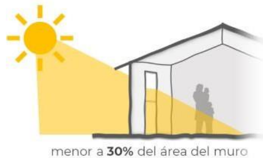
Gráfico N° 23 Dimensionamiento de vanos en la vivienda
