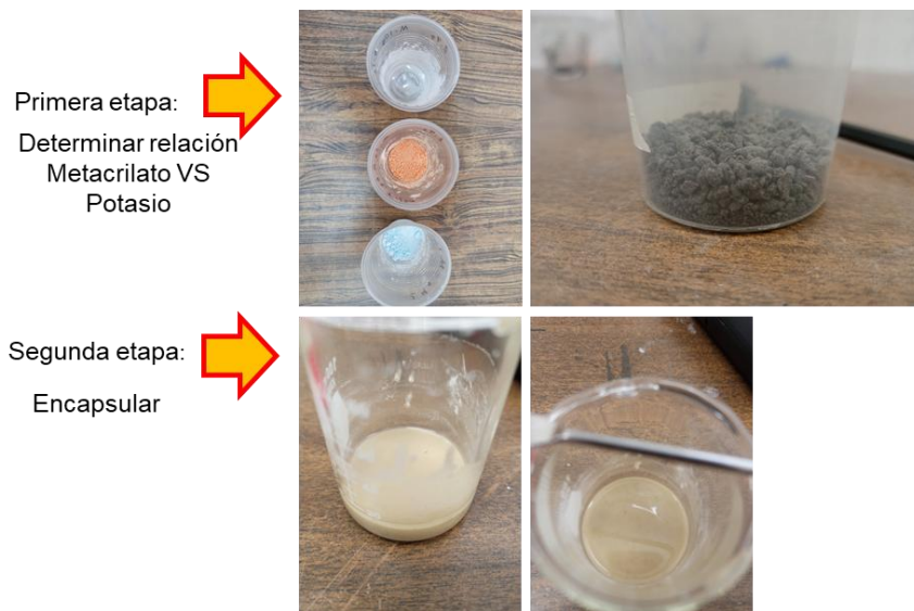
Figura 13. Proceso de encapsulación con PMMA.
