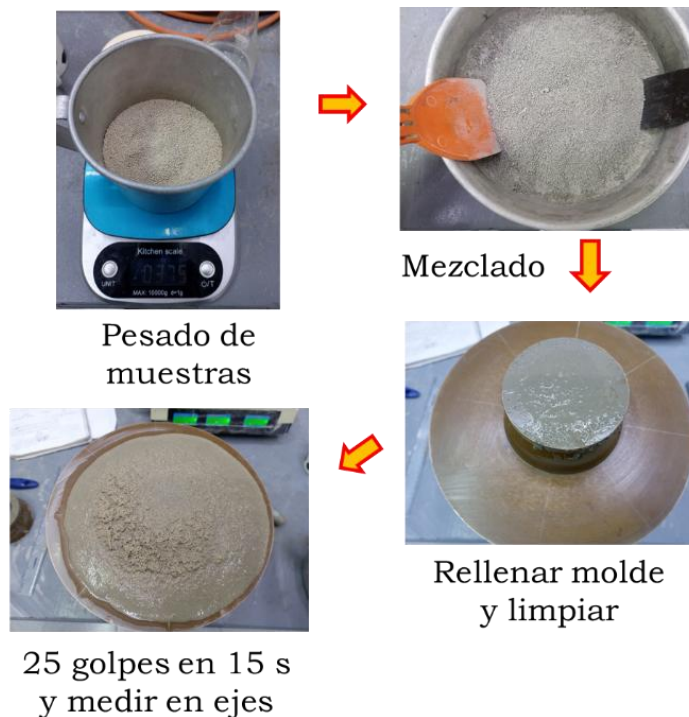
Figura 15. Prueba de fluidez en morteros.
