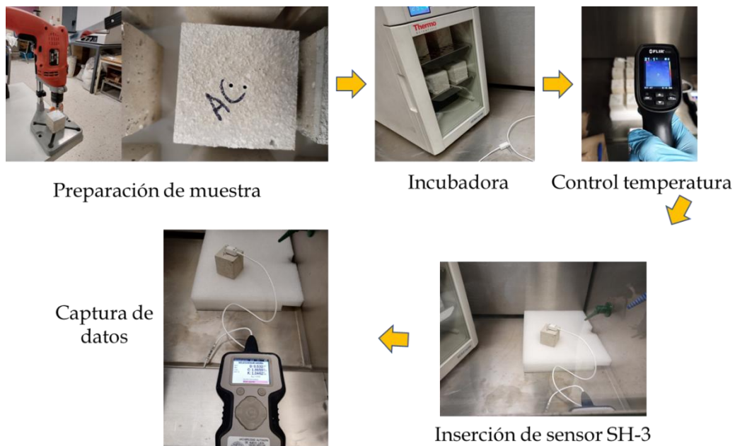
Figura 18. Captura de conductividad, difusividad y capacidad calorífica volumétrica.
