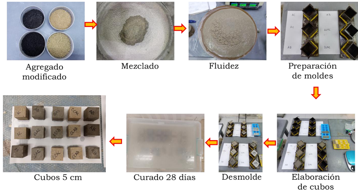
Figura 16. Elaboración de muestras cúbicas de morteros con adición de PCMs.
