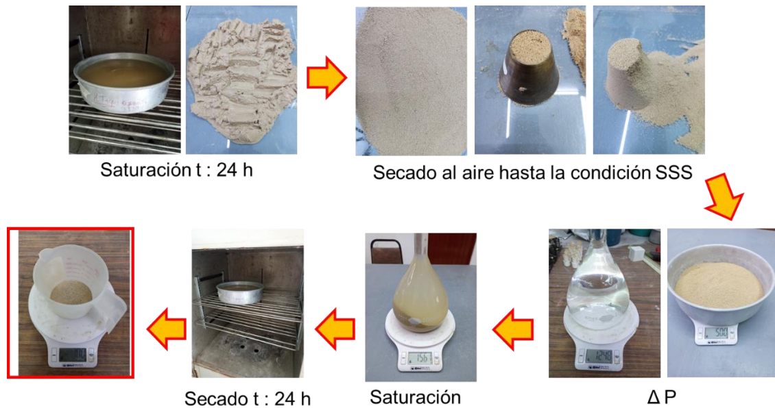
Figura 8. Prueba de densidad y absorción.
