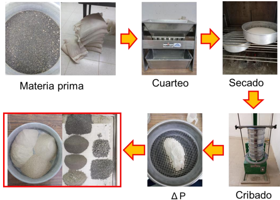
Figura 7. Proceso de granulometría de agregados.
