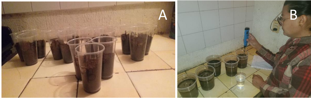
Fig. 12 Toma de medidas de CE en cada tratamiento a evaluar. (A) Recoleccion de toma de muestras; (B) Toma de parametros de conductividad electrica.
