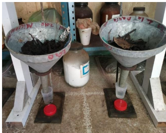
Figura 3. Embudo de Berlese-Tullgren para la recuperación de organismos de la hojarasca y el suelo.
