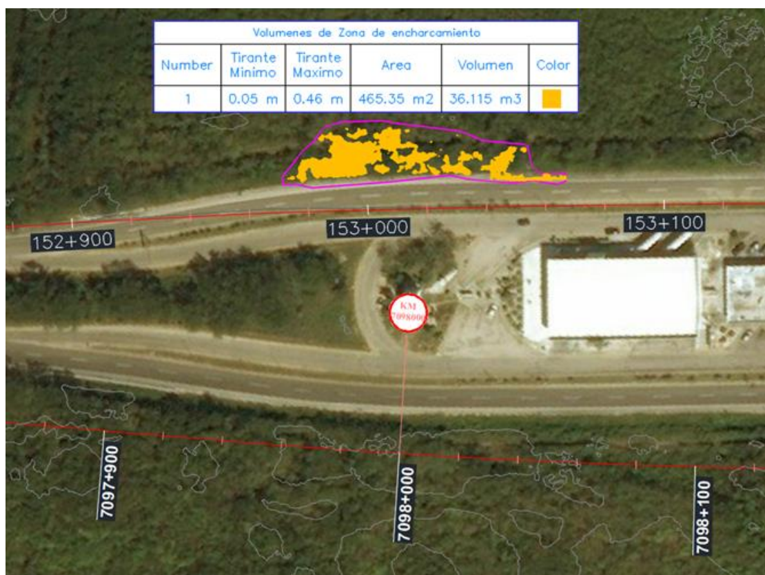
Figura 9. Área de zona de encharcamiento de estudio de la estación 153+00, Depresión 01.
