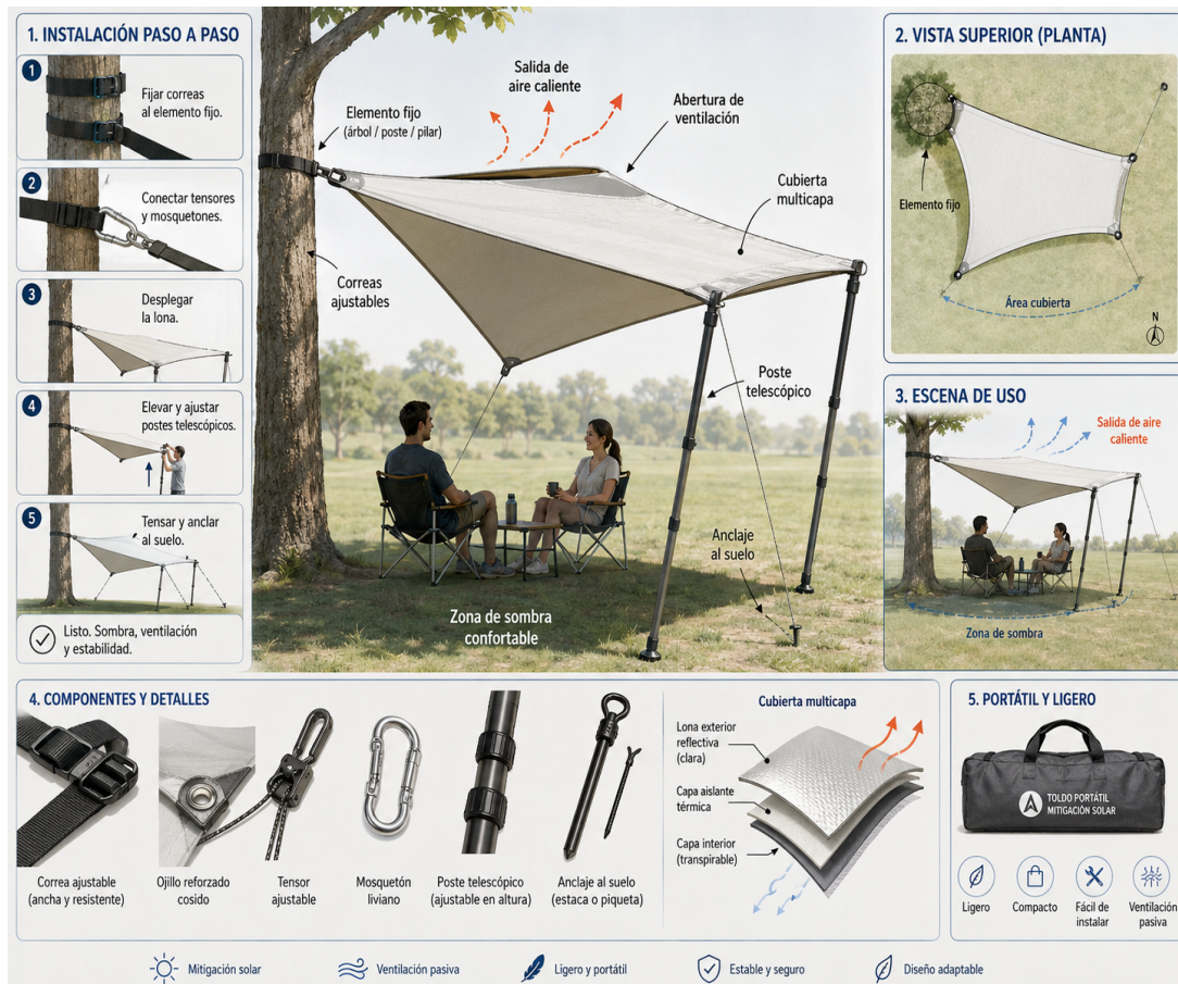
Figura 3.32: Boceto diseño de toldo ajustable
