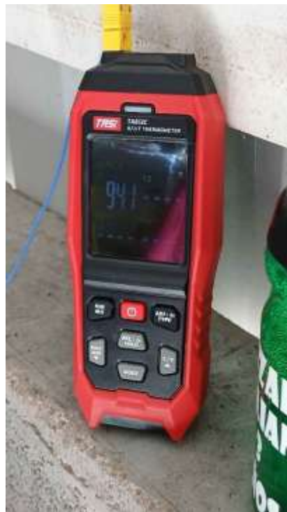
Figura A4. Registro de la temperatura final interna de la vaporera en una prueba de Etapa 1.
