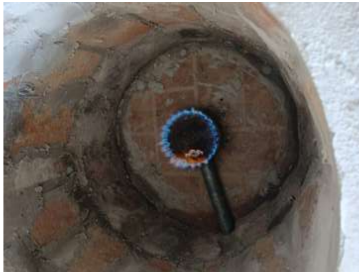
Figura 35. Vista del soplete funcionado dentro de la cámara de cocción.
