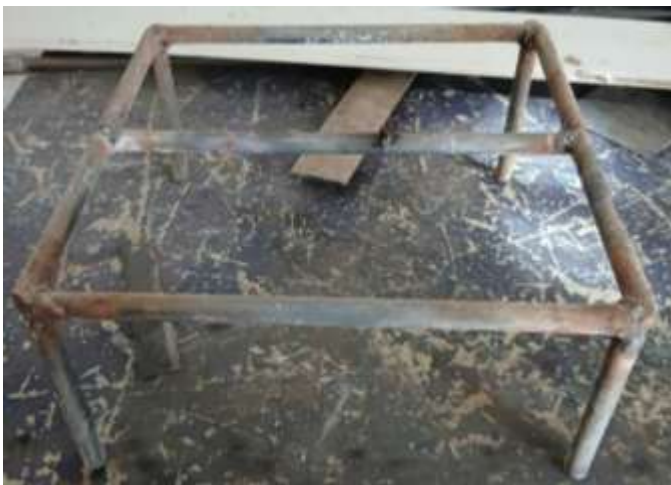
Figura 37. Utensilios de comida para la puesta en operación del horno: estructura de soporte para la vaporera (izq.) y vaporera para la cocción (der.).
