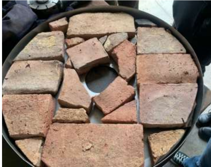
Figura 29. Ensamble de cubierta refractaria en la tapa.
