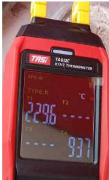
Figura A5. Registro de la temperatura final en el interior del horno (T1) [lectura superior] y en el interior de la vaporera (T4) [lectura inferior] en una prueba de Etapa 2.
