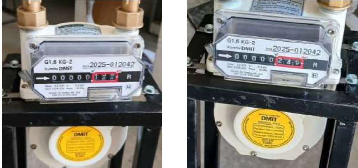
Figura A3. Flujo ( \text{dm}^3 ) de consumo de gas LP inicial (izq.) y final (der.) de una prueba de Etapa 1.
