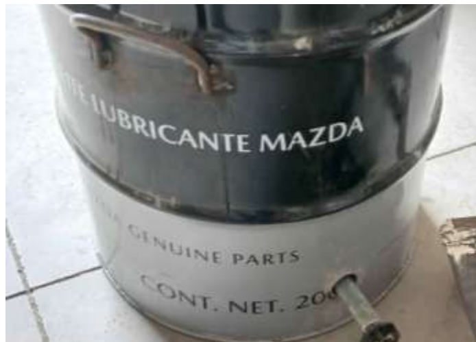
Figura 27. Elemento de sujeción (agarradera) e integración del quemador de gas en la carcasa cilíndrica.
