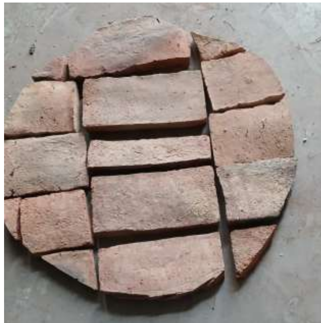
Figura 25. Ensamble de ladrillos refractarios para la base de la cámara de cocción.
