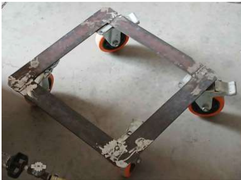
Figura 33. Plataforma de soporte portátil para el desplazamiento del horno.
