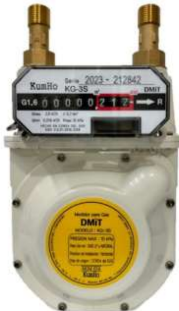
Figura 14. Medidor KumHo DMiT KG-2 de consumo de gas empleado.
