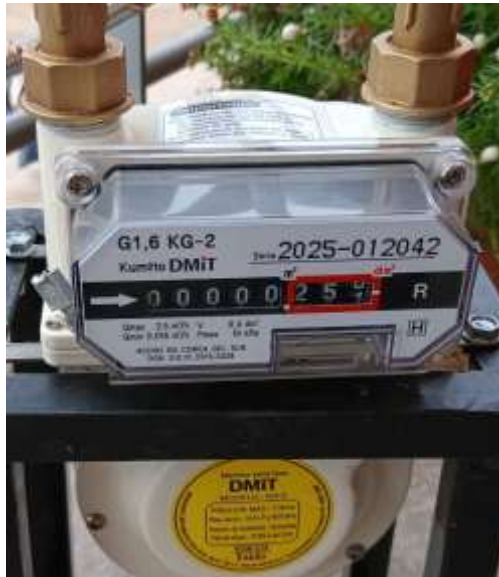
Figura A7. Flujo ( \text{dm}^3 ) de consumo de gas LP inicial (izq.) y final (der.) de una prueba de Etapa 2.
