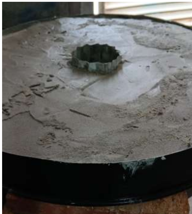
Figura 30. Acabado final del interior refractario de la tapa.
