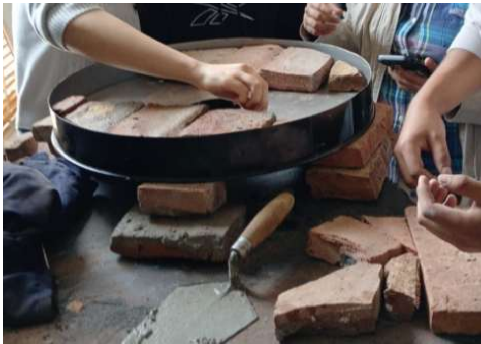
Figura 28. Proceso de fabricación de recubriendo refractario en la tapa.
