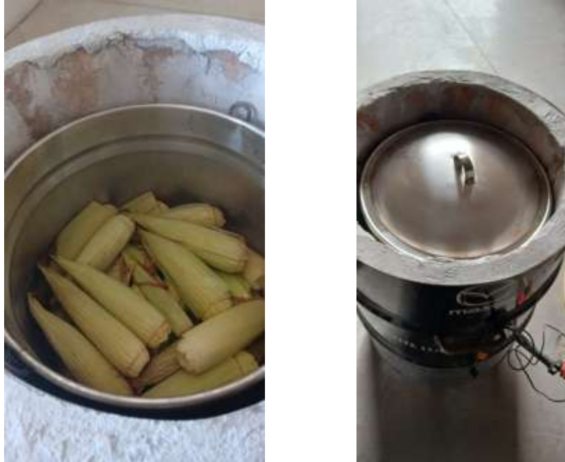
Figura 41. Sistema puesto en el interior del horno: vista de la biomasa dentro de la vaporera (izq.) y vaporera sellada (der.).
