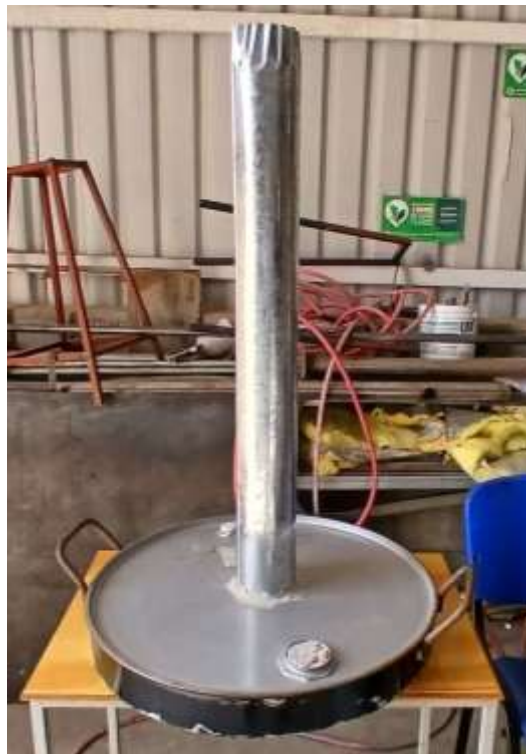
Figura 32. Vista completa de la tapa y chimenea del horno.
