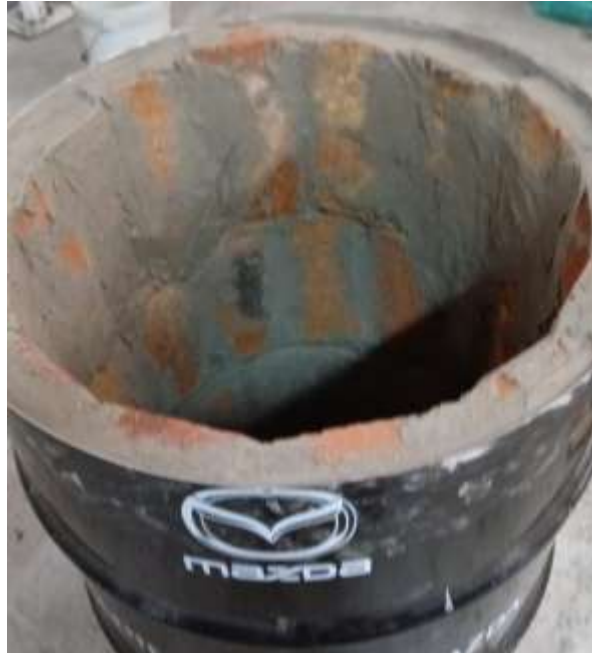
Figura 24. Cámara de cocción con el recubrimiento refractario en sus paredes.
