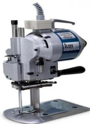
Figura 25: Cortadora de tela manual (Ciseau de Coupe A Lame Verticale KM KSAU- Tip-top, s.f.)
