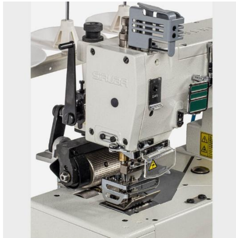
Figura 28: Maquina para pretinar (Base Plana Tipo Pretinadora – Siruba-Amexicol, s.f.)
