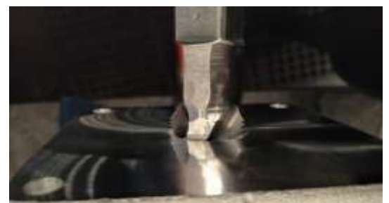
Imagen 64. Uso de barreno semicónico
