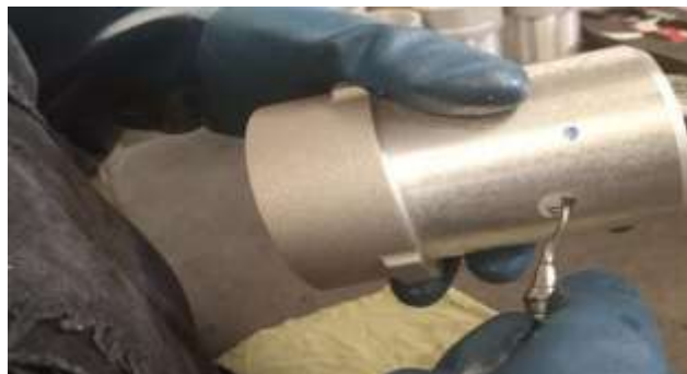
Imagen 71. Remoción de rebaba en la pieza
