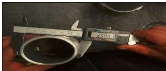
Imagen 67. Verificación del mecanizado
