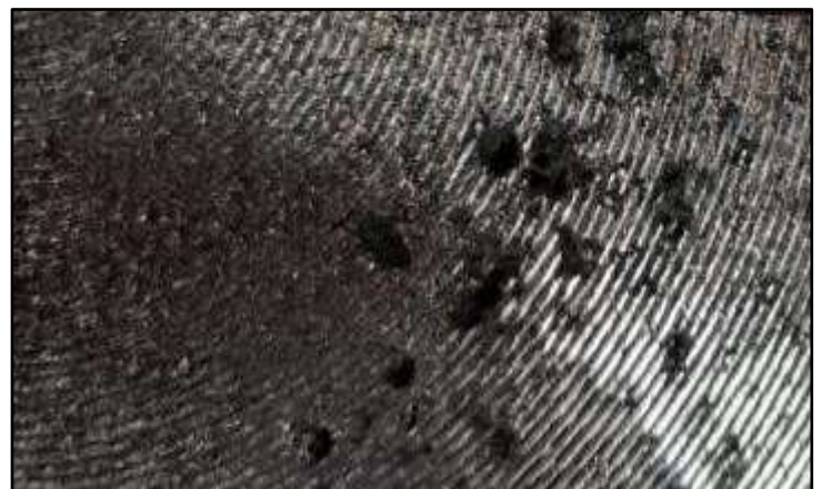
Imagen 4. Escoria en la superficie del metal
