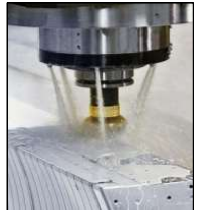
Imagen 12. Trabajo con refrigerante
