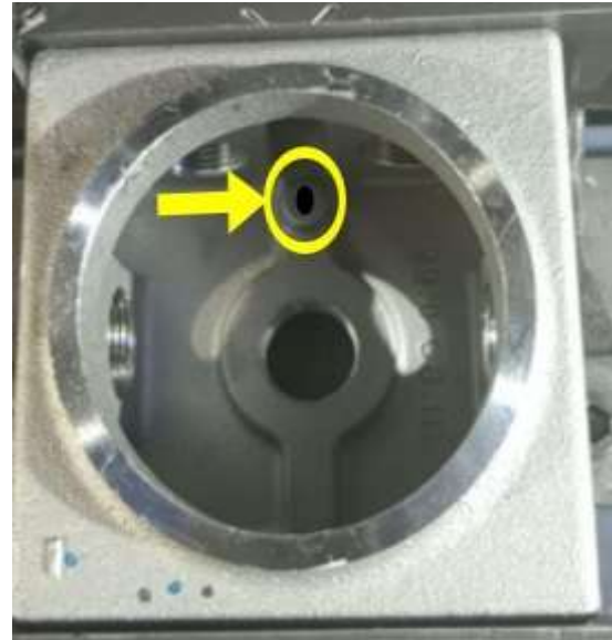
Imagen 47. Barreno interior del Unilet
