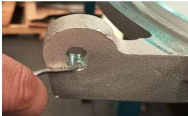
Imagen 92. Rebabeo en orejas de la pieza
