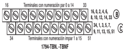
6 Módulo de relé de 8 salidas FLEX I/O (Cat. No. 1794-OW8)
