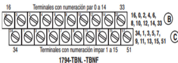
Figura 2.2 Terminales de la base del módulo.
