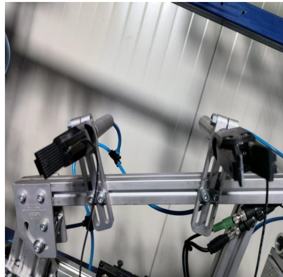
Ilustración 23 Distribución de pinzas para los finales de brazo, Euwe Eugen Wexler, 2025
