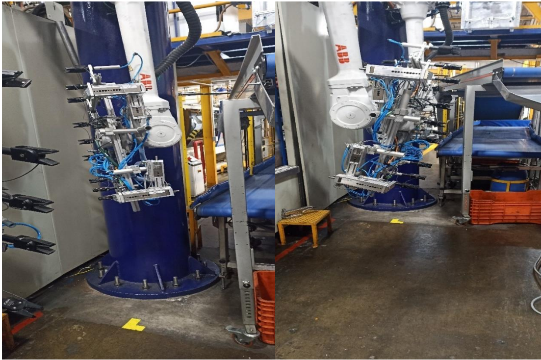
Ilustración 27 Finales de brazo montados en los 2 robots ABB master y esclavo, Euwe Eugen Wexler, 2025
