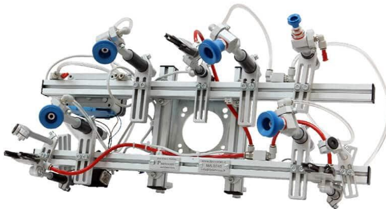
Ilustración 3 Final de Brazo, por Privarsa, 2019, https://www.privarsa.com.mx/herramientas-fin-brazo-la-respuesta-a-tus-retos-de-produccion/
