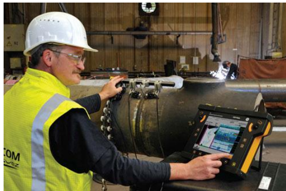
FIGURA 91. INSPECCION DE SOLDADURA POR ULTRASONIDO
