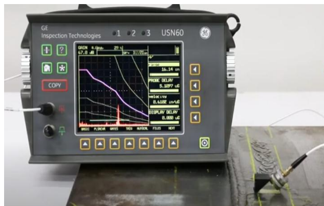
FIGURA 112. INSPECCION DE SOLDADURA POR ULTRASONIDO
