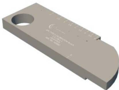
FIGURA 87. BLOCK IIW TIPO 1
