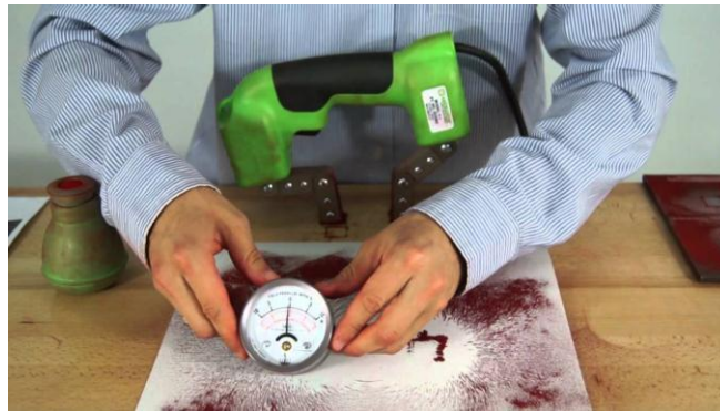
FIGURA 105. COMPROBACION DEL CAMPO MAGNETICO CON MEDIDOR GAUSS
