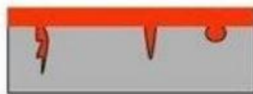
2.-Aplicación de PENETRANTE
