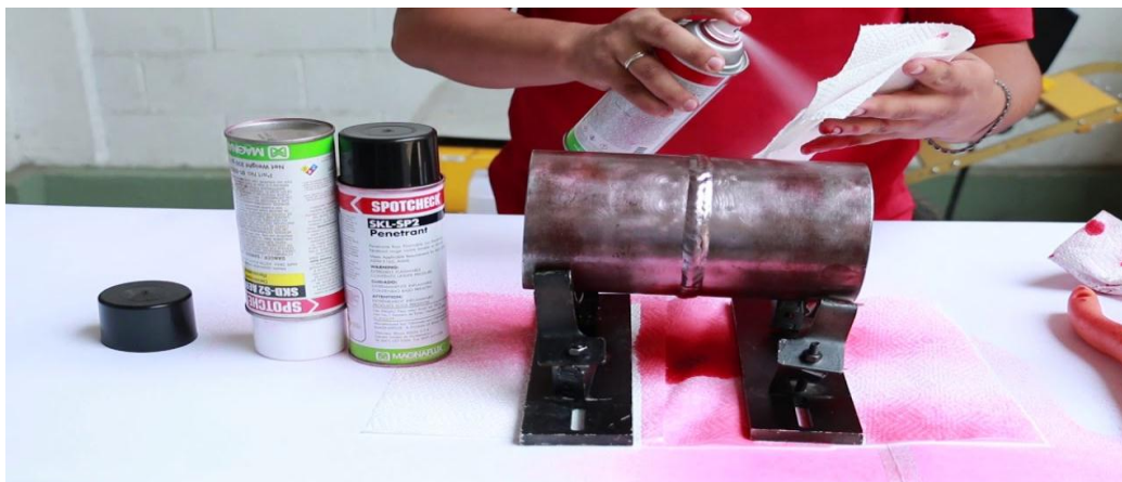
FIGURA 51. APLICACIÓN DE PENETRANTE
