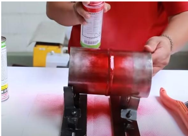
FIGURA 100. APLICACIÓN DEL PENETRANTE
