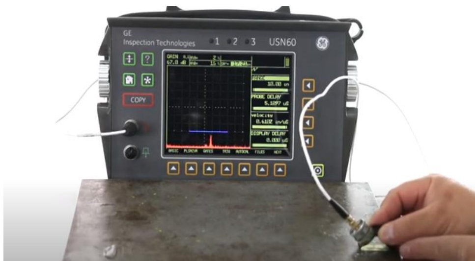
FIGURA 110. VERIFICACION QUE EL AREA A INSPECCIONAR SE ENCUENTRE LIMPIO
