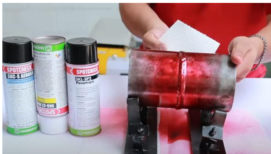
FIGURA 101. REMOCION DEL EXCESO DE PENETRANTE
