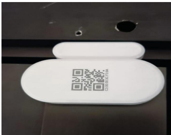
Ilustración 28 Ubicación de Sensor de puerta (Autoría Propia)
