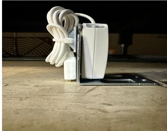
Ilustración 18 Colocación correcta de Sensor (Autoría Propia)
