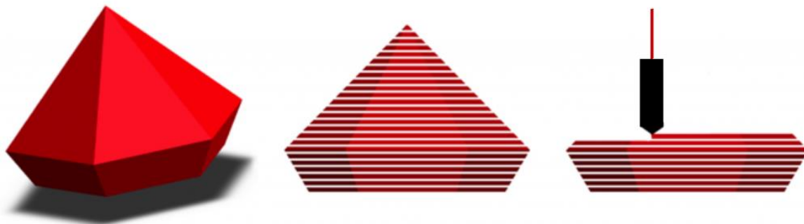
Fig. 15 Ejemplo de modelado a impresión capa por capa
