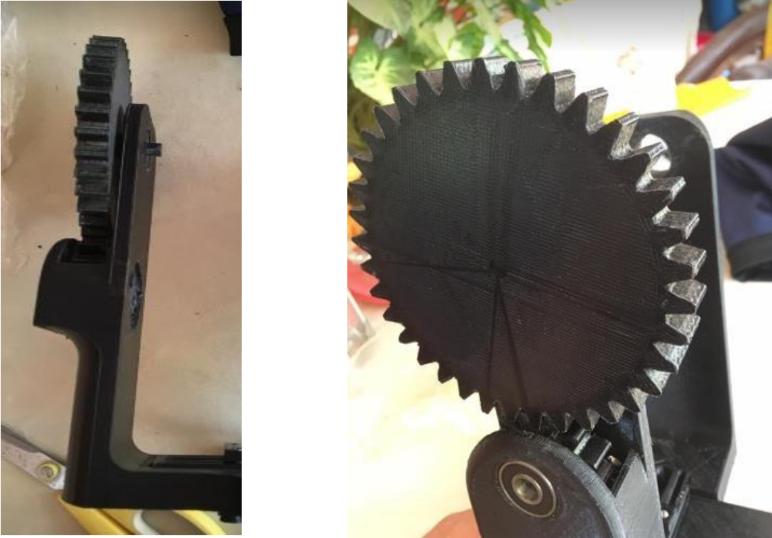
Figura 31.- Juego de engranes instalado: vista exterior (derecha) y vista lateral.
