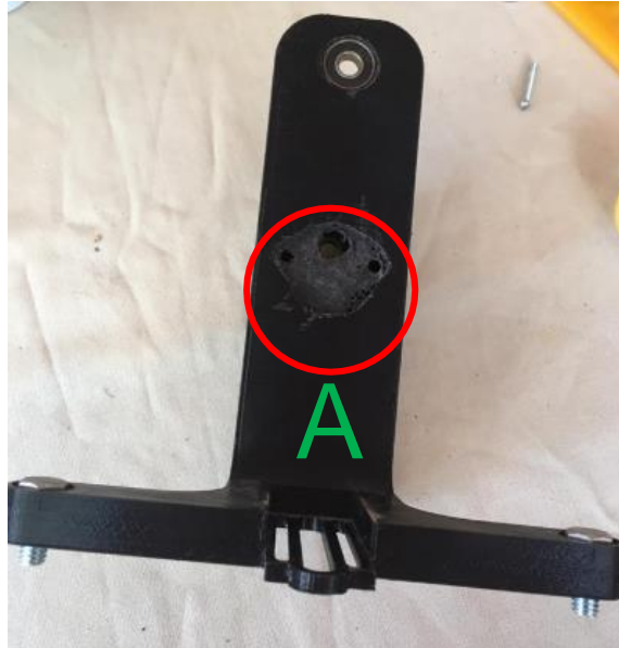
Figura 28.- Pieza A: hueco para motor BYJ48.
