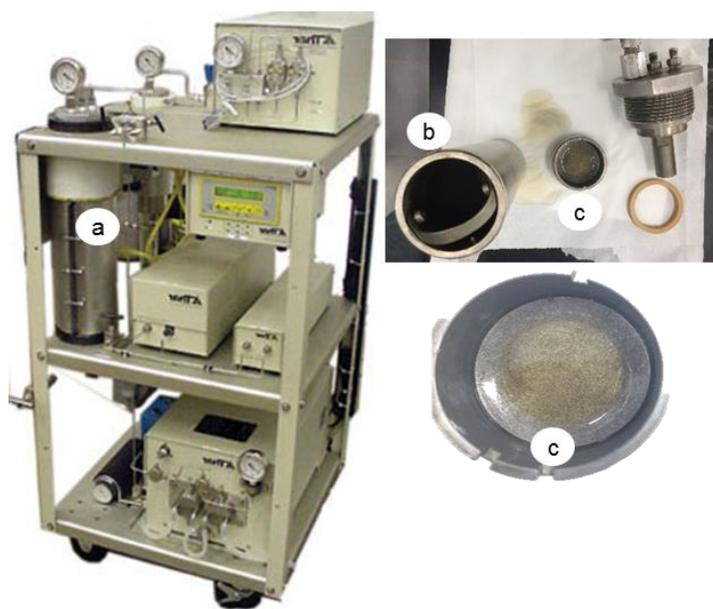
**FIGURA 5.26.** Sistema de precipitación en fluidos supercríticos Thar Technologies 200. a) celda de precipitación, b) canastilla, c) filtro de separación.
