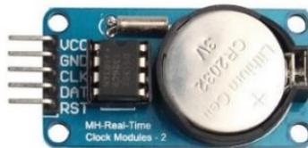
Figura 3.6. Módulo de tiempo Real (RTC 1302).
