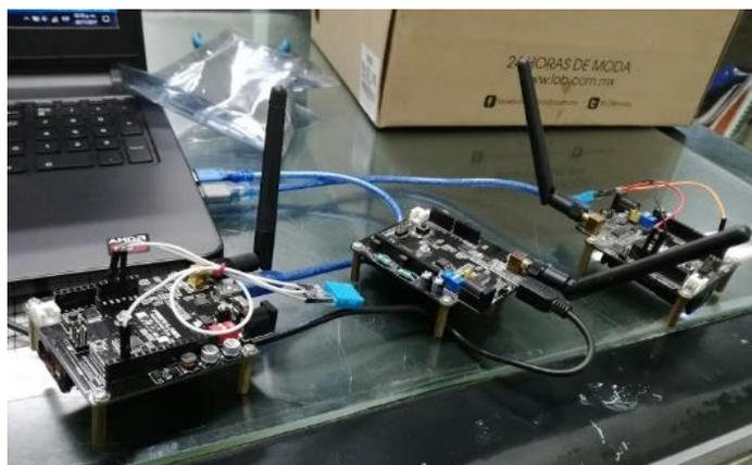
Figura 4.3. Programación de sensor DHT11.
