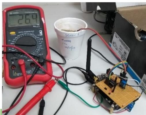
Figura 4.8. Medición de consumo energético con nodo activo.
