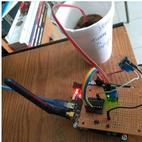
Freakduino con MCP3208 y sensores.
