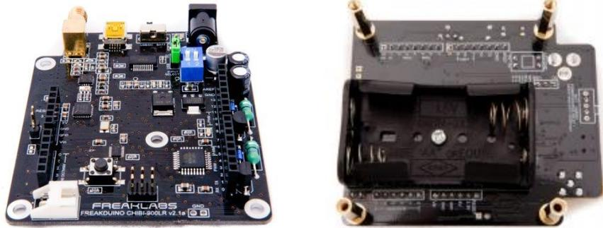
Figura 2.4. Freakduino 900 MHz v3.0a parte superior e inferior.
