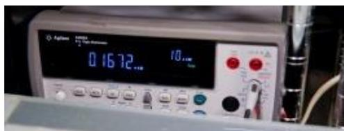
Figura 4.9. Medición de consumo energético con nodo inactivo.
