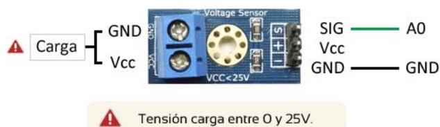
**Figura 2.14. Sensor de voltaje FZ0430.**
