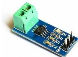
Figura 2.15. Sensor de corriente ACS712.
