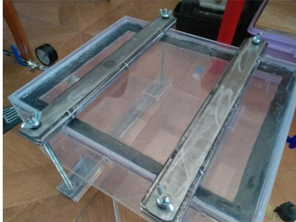
**Figura 3.3** Sellado de la Cámara de gas.
