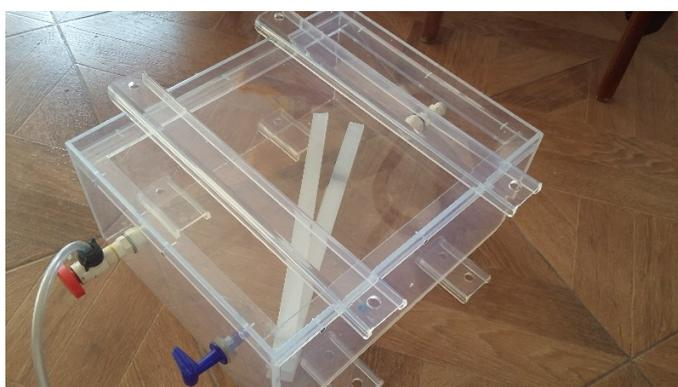
**Figura 3.2** Cámara de gas principal hecha en acrílico
