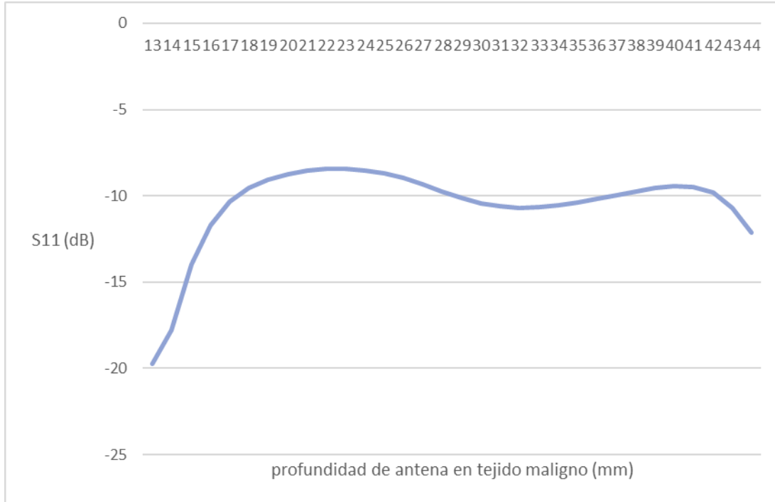
Figura 2.22 Resultado de un barrido en cubo, respecto a la tasa de reflexión con respecto a la profundidad de la antena en tejido maligno.
