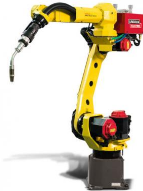
Figura 3.1: Robot manipulador serial Fanuc modelo ARC Mate 100iC/12.
