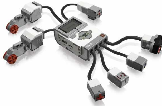
Figura A.1: “Ladrillo” inteligente, sensores y actuadores del kit LEGO MINDSTORMS EV3
